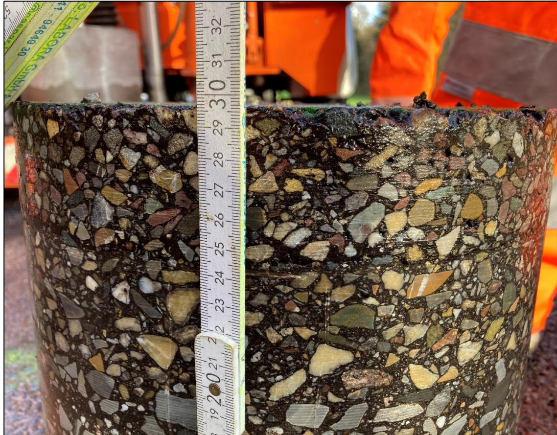
24.11.2022, 300 mm Bohrkern, Station 1+800 SMA 11 S, 25/55-55 A RC mit 30 M.-% Asphaltgranulat OPA mit Gummibitumen
