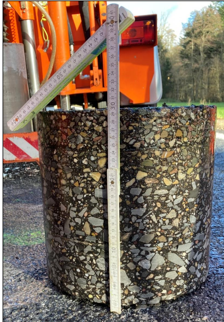
24.11.2022, 300 mm Bohrkern, Station 1+800 SMA 11 S, 25/55-55 A RC mit 30 M.-% Asphaltgranulat OPA mit Gummibitumen
