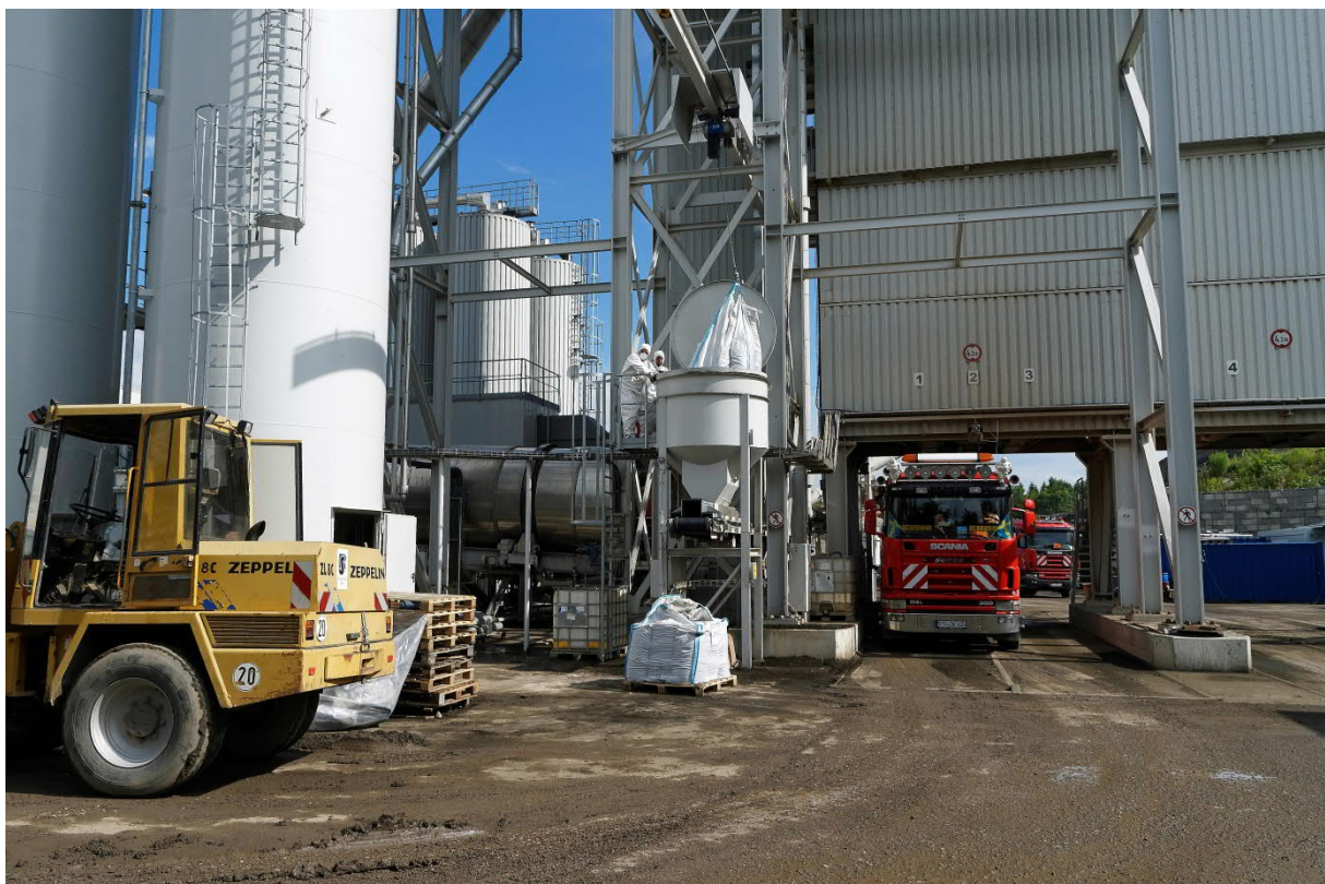
Bild 3: An der Asphaltmischanlage in Gilching stand eine automatische Dosiereinrichtung für das Gummimodifizierte Bitumengranulat CTS GRM 40/20 zur Verfügung. Die Anlieferung erfolgte dort in Big Bags mit einem Gesamtgewicht von 500 kg.
