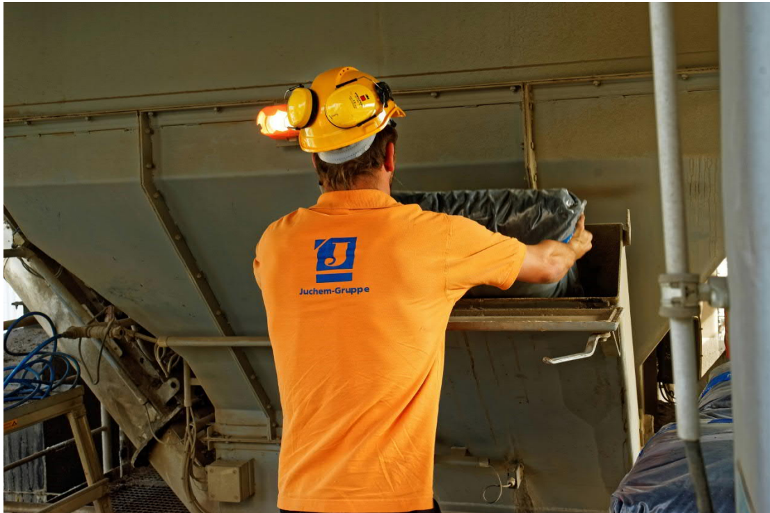
Bild 2: Manuelle Dosierung an der Asphaltmischanlage Landau
