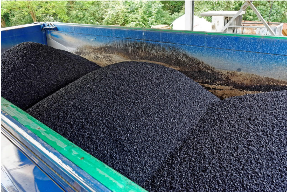
Bild 3: Das Asphaltmischgut AC 8 D S weist ausgeprägte Schüttkegel auf.
